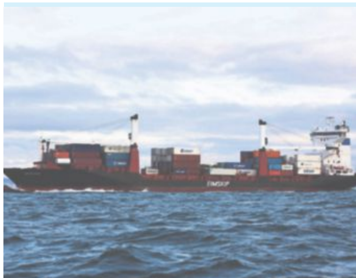
EIMSKIP: MS Dettifoss ble bygget i 1995, er 165,6 meter lang og 28,6 meter bred. Skipet uten last veier 14 664 tonn.
