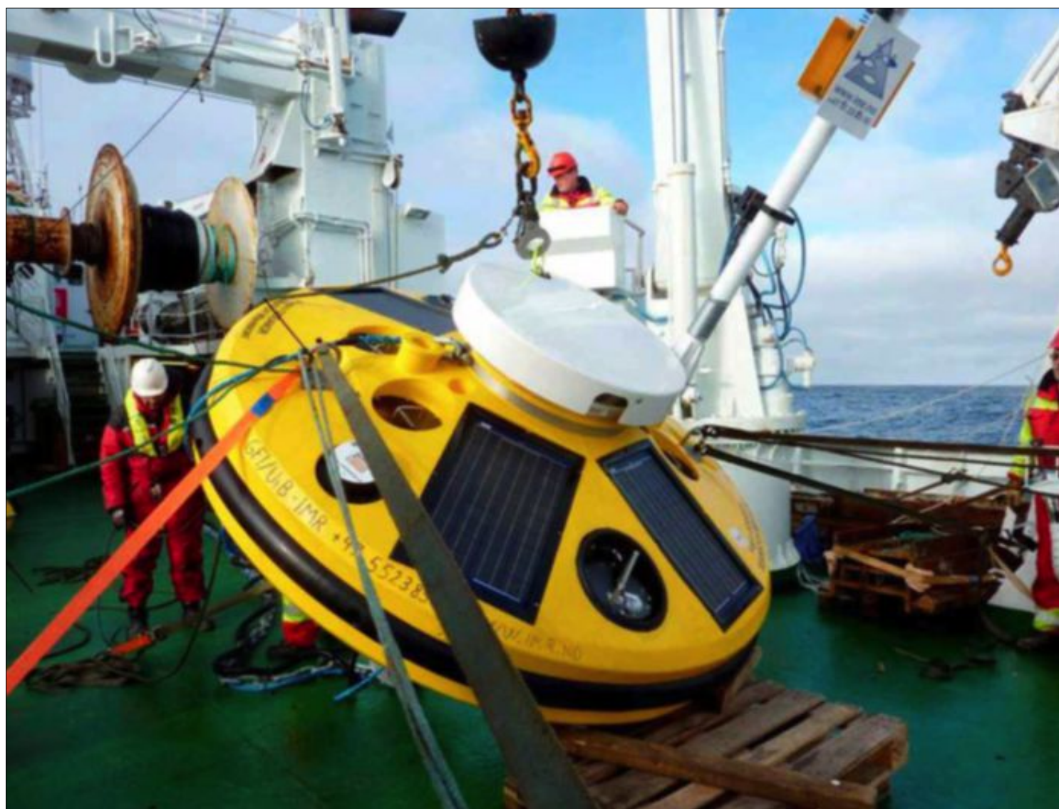
MÅLESTASJON: Det er allerede plassert ut 25 målestasjoner som denne til havs. Målet er å komme opp i 60. De skal sende informasjon om mengden CO 2 i havet. På den måten måles både utslippsmengder og hvor mye som tas opp av havet.
